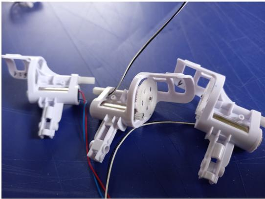
**3 x Getriebe 6:1 Ø 7,00mm Motor**
