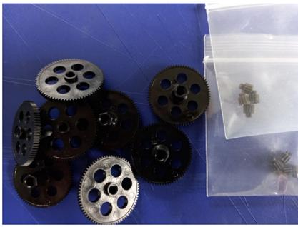
8 x Zahnrad  $\varnothing$  3,00mm Achse
